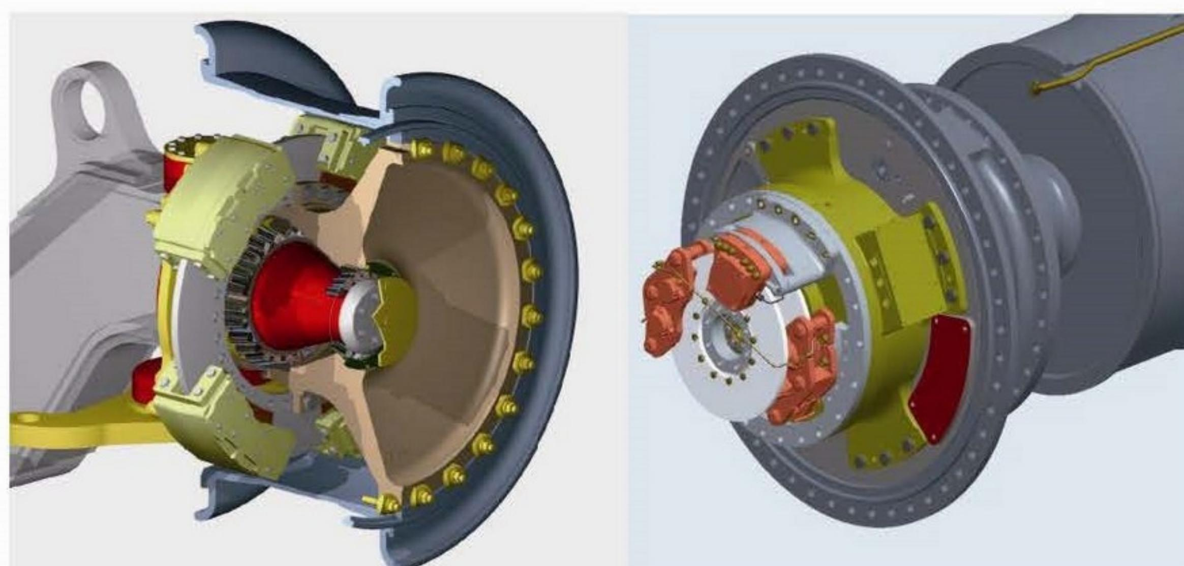
轻便的工作制动，辅助制动，装载制动，弹簧施压，液压释放的驻车制动。储能器 (3 个) 保证在紧急情况下，提供足够的安全制动。系统压力低于 2100 PSI 时，系统报警提醒驾驶员注意。
