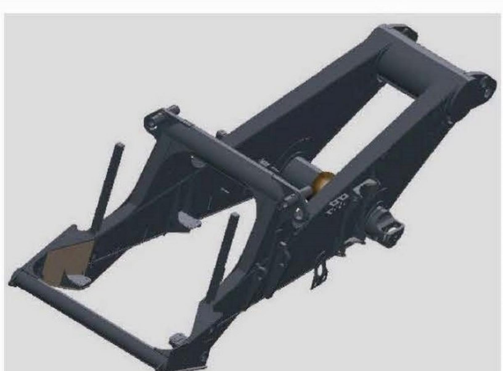
车架主体由变截面的箱形直纵梁和圆柱形横梁焊接而成，直纵梁设计消除了应力集中，变截面箱形纵梁结构降低了应力，延长了疲劳寿命，圆柱形的横梁结构使车架整体抗扭性能更加优越。车架采用先进焊接工艺，提高了焊缝的耐久性，延长了疲劳寿命。
