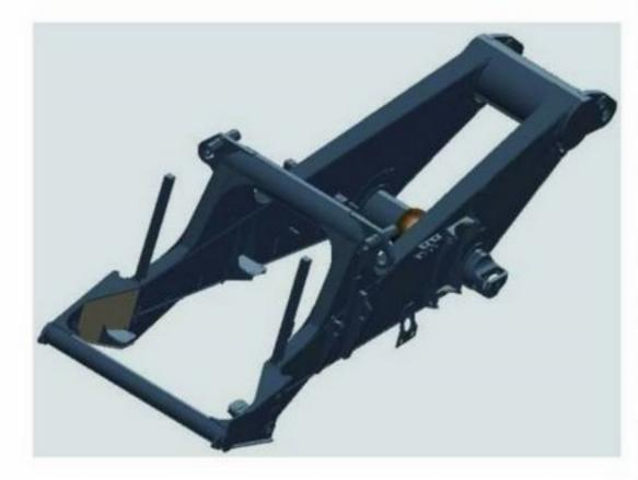
车架主体由变截面的箱形直纵梁和无缝管横梁焊接而成,直纵梁设计消除了应力集中,变截面箱形纵梁结构降低了应力,延长了疲劳寿命,无缝管横梁结构使车架整体抗扭性能更加优越。车架采用埋弧焊焊接工艺,提高了焊缝的耐久性,延长了疲劳寿命。
